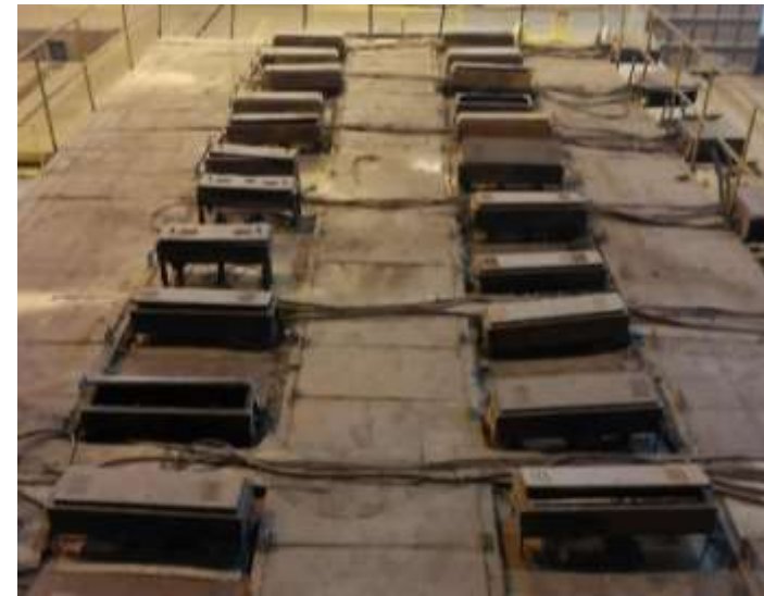
Рисунок 6 – Расположение колориферов на своде печи
