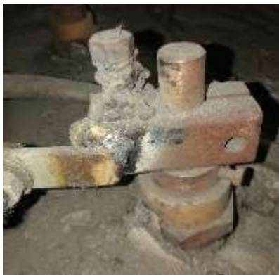
Рисунок 9-Состояние контактных узлов нагревательных элементов (на левом снимке отсутствует стяжной болт, фиксация узла на стержне за счет сварки)
