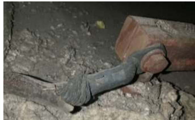
Рисунок 8-Следы перегрева зоны контакта (почернение клемм и жил кабеля, обгорание изоляции, приварка контактного узла)
