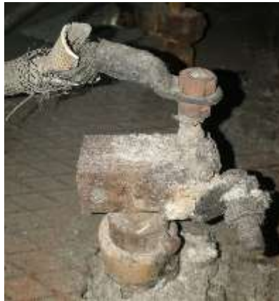
Рисунок 8-Следы перегрева зоны контакта (почернение клемм и жил кабеля, обгорание изоляции, приварка контактного узла)
